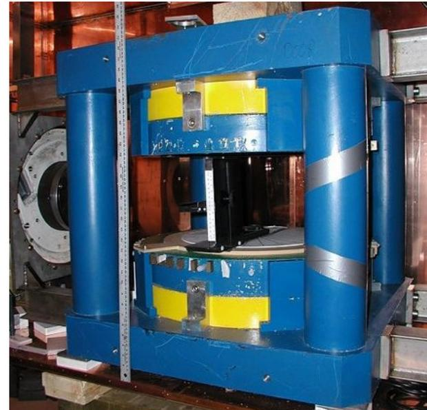
Exemple : Projet Linac-MR : contrôler le positionnement via une IRM pendant le traitement : voir où on traite en temps réel
